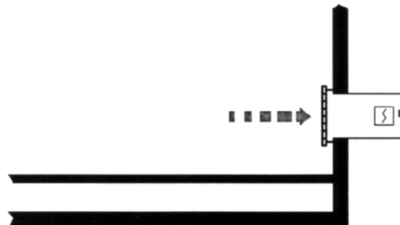
Slika Postavljanje javljača sa bočnim izvlačenjem vazduha
